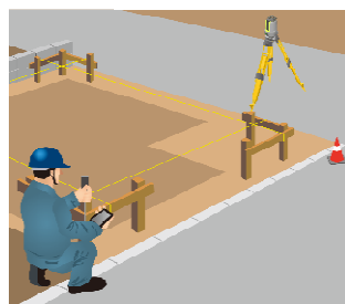
丁張りの設置
