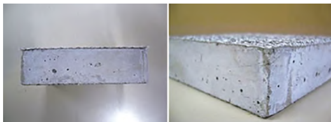
写真1 モルタル_耐候性試験1,000h 曝露後
