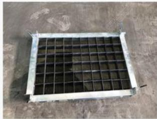
全て組付けたら、外枠2辺を先に組み仕切板に当てるように組みます。
