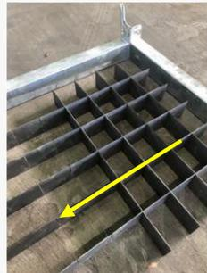
仕切板(長)の端の切り込みを下に、仕切板(短)は切り込みを上向きにしておきます。
